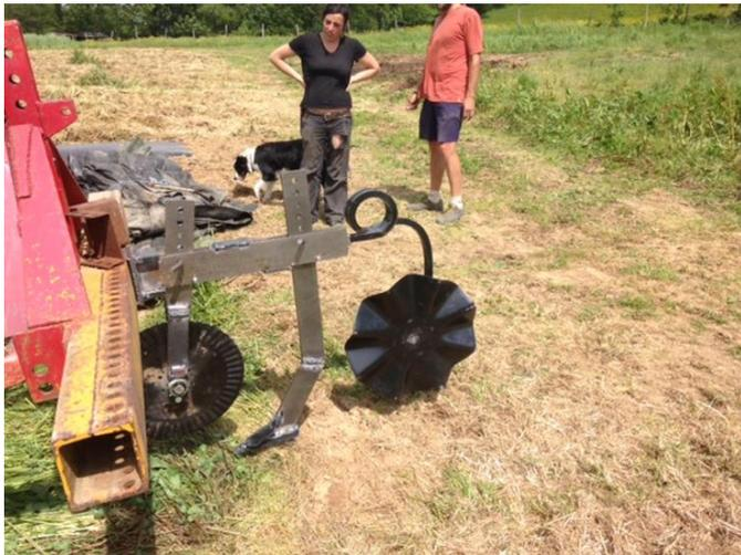
La barre porte outil compte déjà beaucoup d'accessoires, et si les essais de ce nouveau module sont concluants, la famille s'agrandirait d'un outil permettant de tracer un sillon dans un couvert d'engrais vert pour un semi ou une plantation. Cette technique est encore dans ses balbutiements, mais avec tous les acteurs (Buzuk, SEFERSol, GRAB) qui œuvrent dans cette voie, il est certain que des itinéraires vont s'affirmer pour aller dans le sens d'une agriculture de plus respectueuse des sols.
