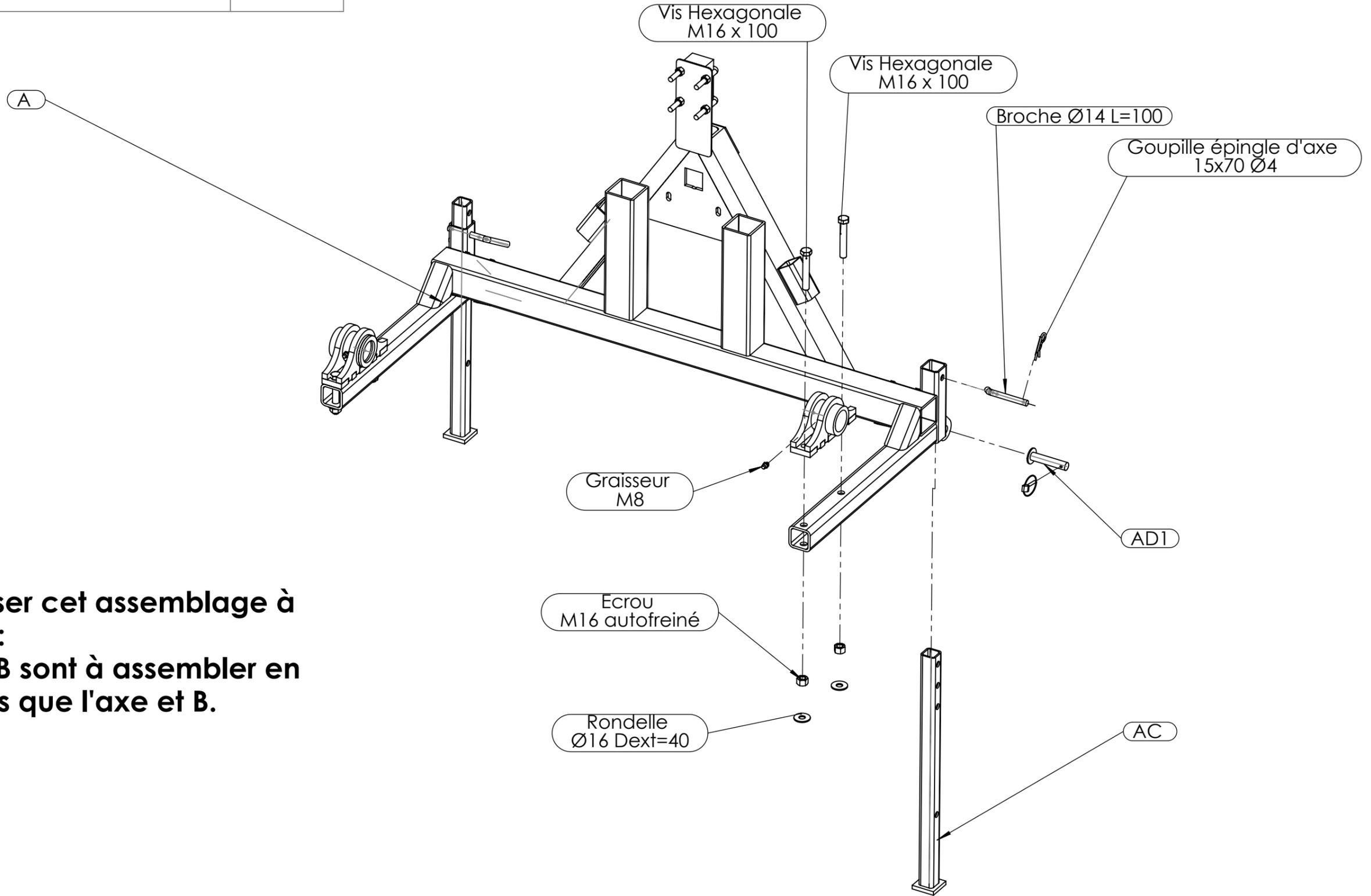
**Ne pas réaliser cet assemblage à cette étape : les pièces AB sont à assembler en même temps que l'axe et B.**
