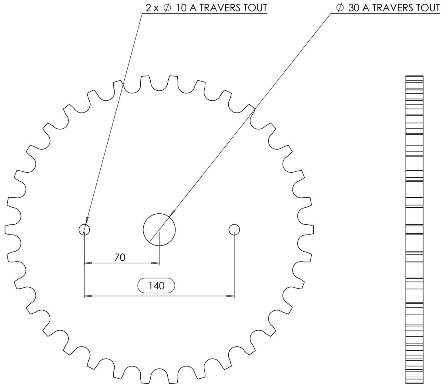
Le plateau ref PW134 est alésé en 25mm à la réception, il faut donc le fraiser en  $\phi 30$  A TRAVERS TOUT ainsi que percer les trous pour les vis de sécurité,  $2 \times \phi 10$  A TRAVERS TOUT.
