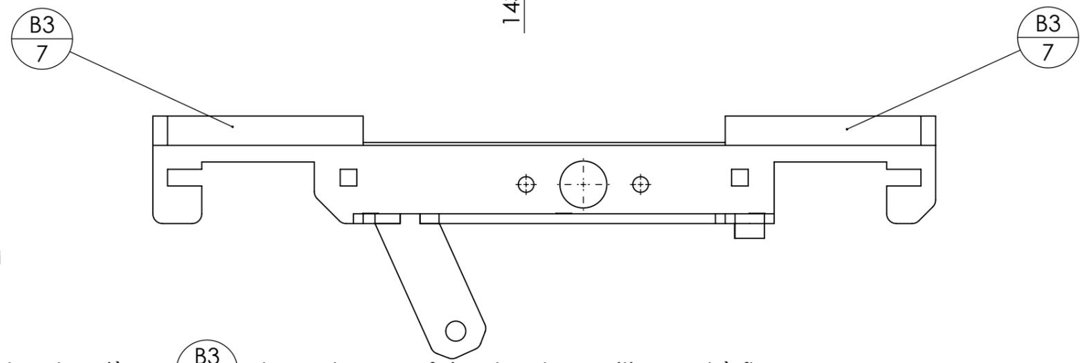
Les tôles  $\frac{B2}{2}$  viennent s'emboîter dans les pièces  $\frac{B3}{7}$ , le centrage se faisant en les positionnant à fleur.
