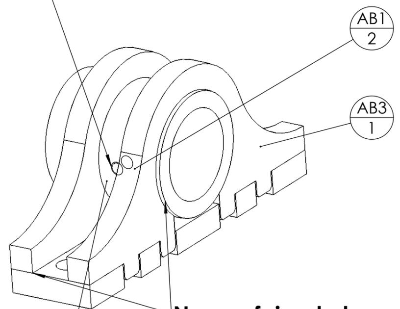
**Ne pas faire de trop gros cordons de soudure pour ne pas gêner les assemblages suivants.**
