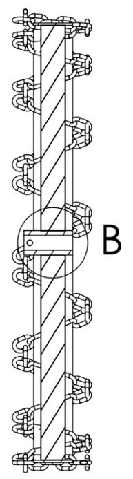
Soudage des maillons de chaîne sur le bord de la roue
