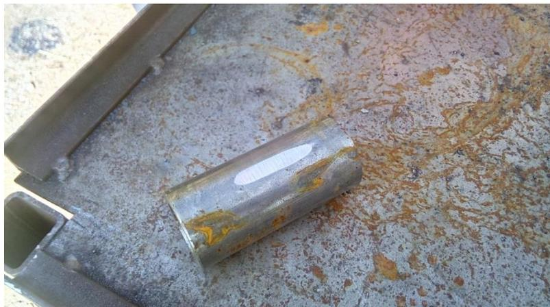
*Photo2 : mettre un coup de pointeau pour centrer et guider la mèche lors du perçage*
