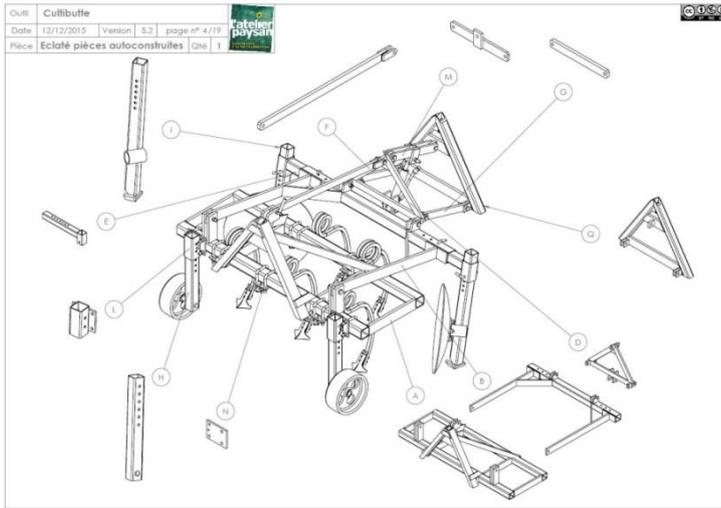
Une lettre ou ensemble de lettres correspond à un assemblage soudé. Ces assemblages figurent dans les nomenclatures de présentation (voir tableau *figure 4*) ou les éclatés généraux (voir *figure 1*).
