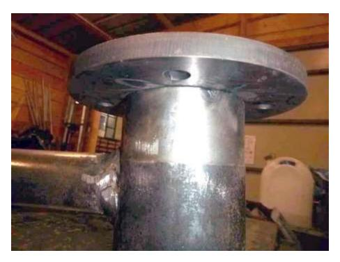
**5/ Repositionner le roulement de bout d'axe.** L'insertion de l'axe/coupelle a tendance a faire ressortir le roulement extérieur. Il est nécessaire de le retaper dans le fond du moyeu.
