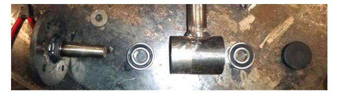
Voici l'ensemble des pièces dont on a besoin pour le montage, présentées comme un éclaté (plan page 1). De gauche à droite : axe/coupelle, roulement avec diamètre interne le plus gros, moyeu, roulement avec diamètre interne plus petit, circlips (peu visible sur la photo) et cabochon.
