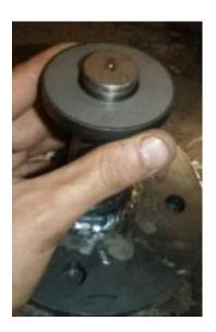
Ensuite on soude cette bague sur un tube et un plat en bout de tube pour pouvoir taper à la massette. Le tube doit être assez gros pour que le bout de l'axe rentre dedans.
