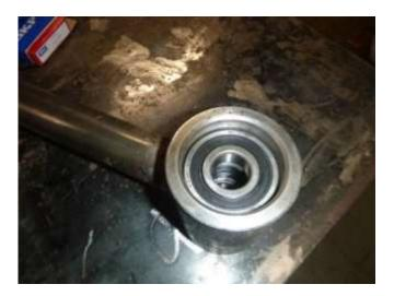
**3/ Montage de l'axe/coupelle**. On insère l'axe d'abord sur le roulement au diamètre intérieur le plus important.
