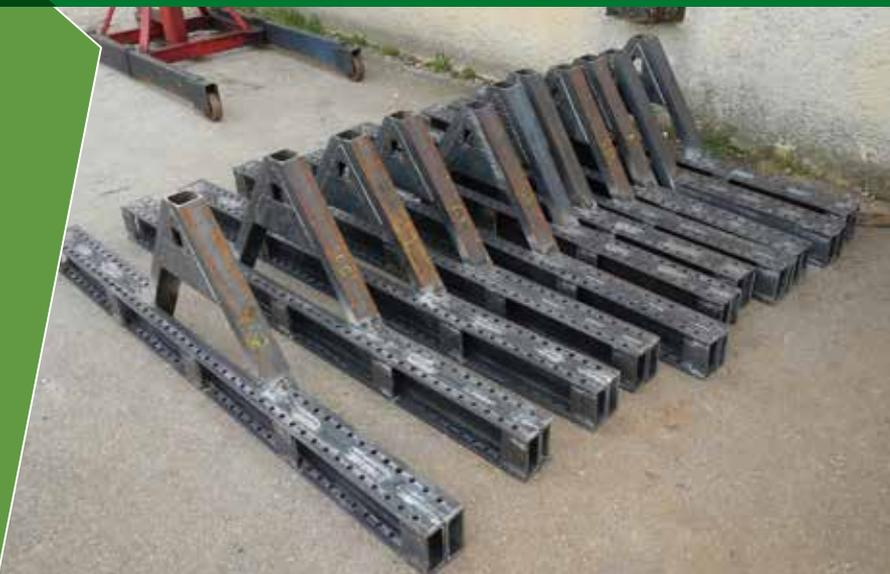
Un outil très simple et polyvalent : deux tôles pliées en U soudées dos à dos et percées à intervalles réguliers (entraxe 45mm).
