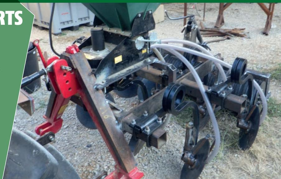
Cet outil est inspiré d'un modèle conçu en 2016 dans le Jura. Afin d'éviter les bourrages en sol couvert, les socs du modèle précédent ont été remplacés par des disques ouvreurs : constituant les éléments techniques centraux de l'outil, ces disques sont soumis à un montage et un support particuliers.
