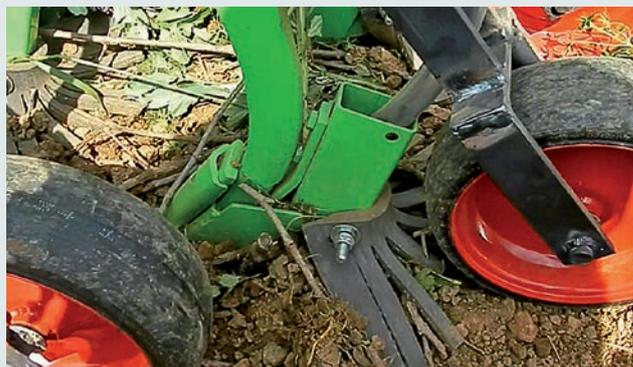
**Attention** : ces roues de rappui ne permettent pas de gérer la profondeur de semis (elles ne sont pas des roues de terrage !).
