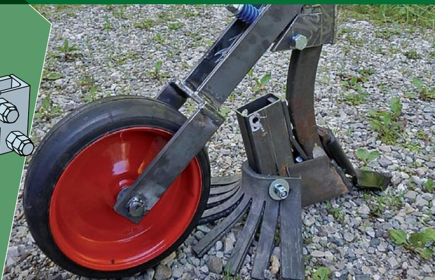
Les nombreux échanges qui ont ponctué les formations à l'autoconstruction de semoirs viticoles, ont permis de faire émerger le besoin de compléter l'outil grâce à l'ajout d'éléments de rappui du sol derrière les socs, afin d'améliorer la germination.
