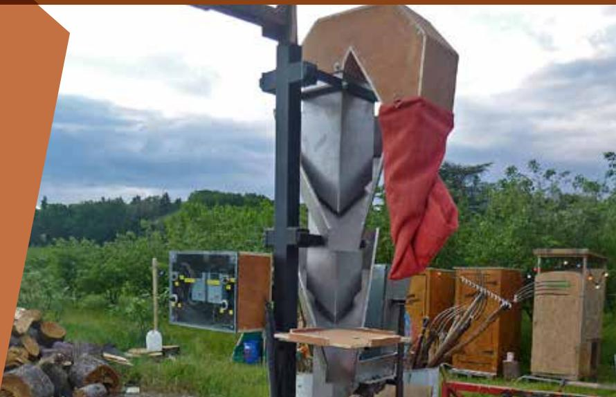
La colonne densimétrique est une solution relativement simple et fine de tri ou nettoyage pour de nombreuses cultures.
