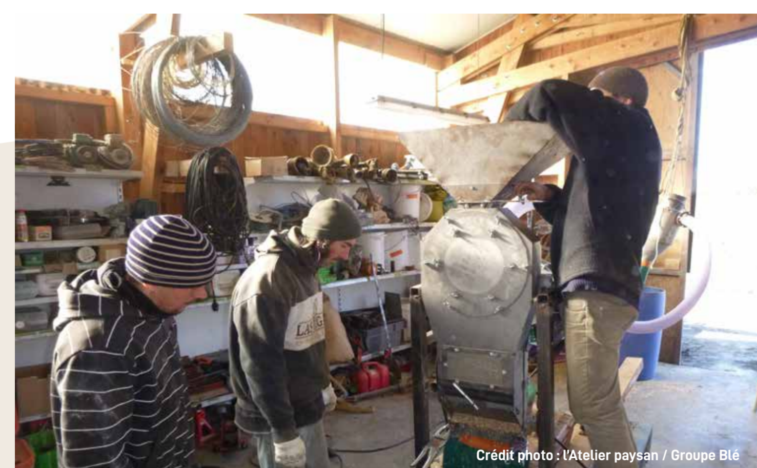
Des membres du groupe Blé de l'ARDEAR AURA au travail sur un prototype de décortiqueur pour l'engrain et le petit épeautre.
