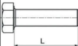
Ex: M10x40 M = Système Métrique  $d = 10\text{mm}$
