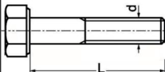
Ex: M12x30 PF M = Système Métrique  $d = 12\text{mm}$
