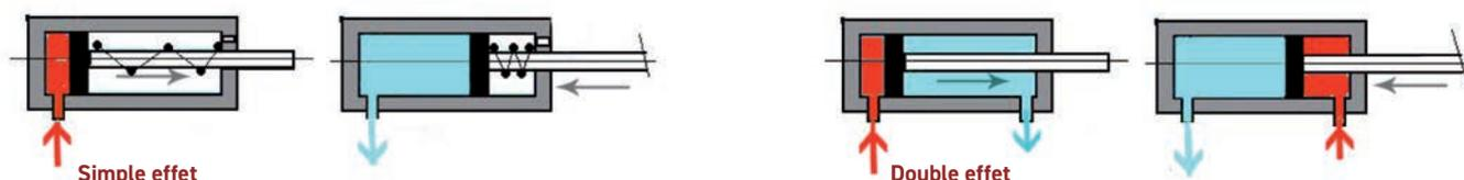
On utilisera le simple effet dans le cas d'outils dont le poids assurera la descente par gravité. Le vérin pourra pousser dans l'autre sens pour assurer la remontée de l'outil. Le double effet est par contre préférable pour les réglages de l'attelage.
