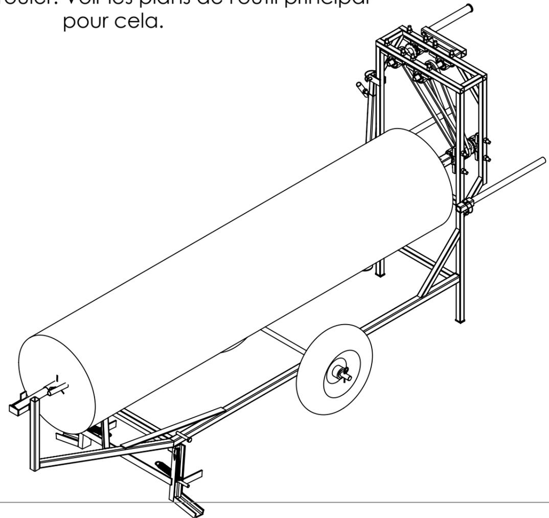
Avec le milieu de la barre support de manivelle à 1163 mm du sol, les axes de manivelles sont à 1129 ou à 1221 mm du sol selon si les paliers sont fixés en haut ou en bas de la barre. Il est possible de modifier cette hauteur LORS DE LA CONSTRUCTION pour s'adapter à la morphologie de l'utilisateur ou de l'utilisatrice. Pour estimer la hauteur la plus adaptée, mesurez la hauteur de vos bras repliés à 90°.
