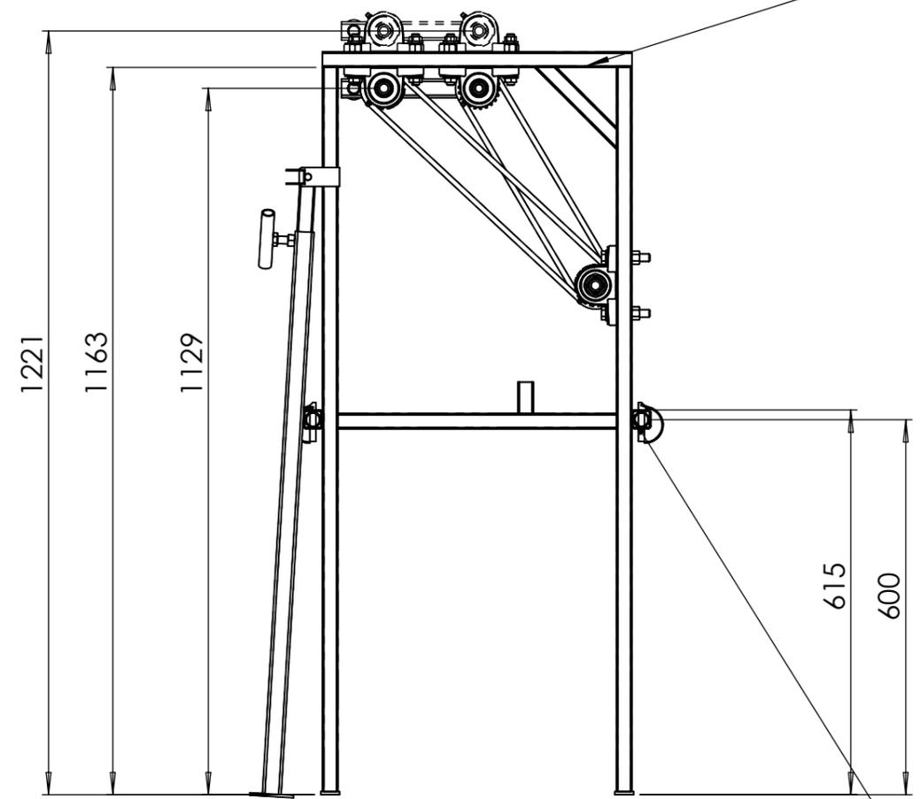
Avec les supports de brancards soudés à 613 mm du sol, les brancards sont à 628 mm du sol. Il est aussi possible d'apapter cette hauteur à la taille des utilisateurs LORS DE LA CONSTRUCTION. Il est possible d'installer plusieurs pièces "support de brancard" pour dans le cas d'utilisateurs variés avec de grandes différences de taille.
